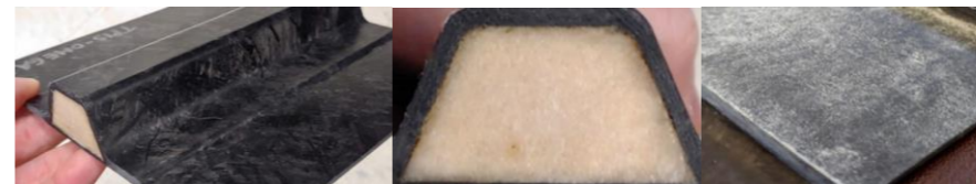
Figure 1 - Raidisseur fabriqué par moulage par compression de SMC avec l'utilisation d'un noyau hydrosoluble Figure 2 - Vue de coupe du raidisseur et du noyau Figure 3 - État de surface de la pièce composite après le retrait du noyau
