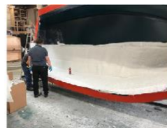
Fabrication de la coque (gelcoat et renforts de fibres de verre)
