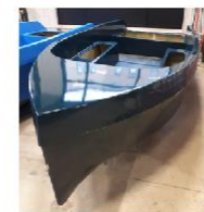
Bateau recyclable en composite thermoplastique (première version)
